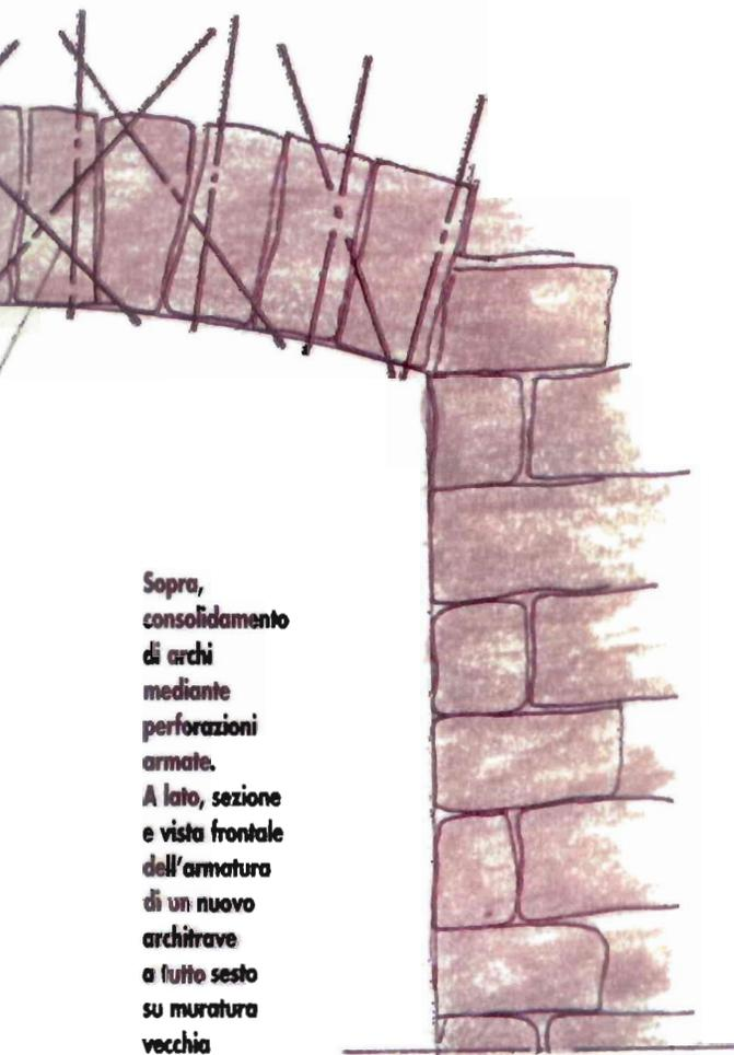
Sopra, consolidamento di archi mediante perforazioni armate. A lato, sezione e vista frontale dell'armatura di un nuovo architrave a tutto sesto su muratura vecchia
