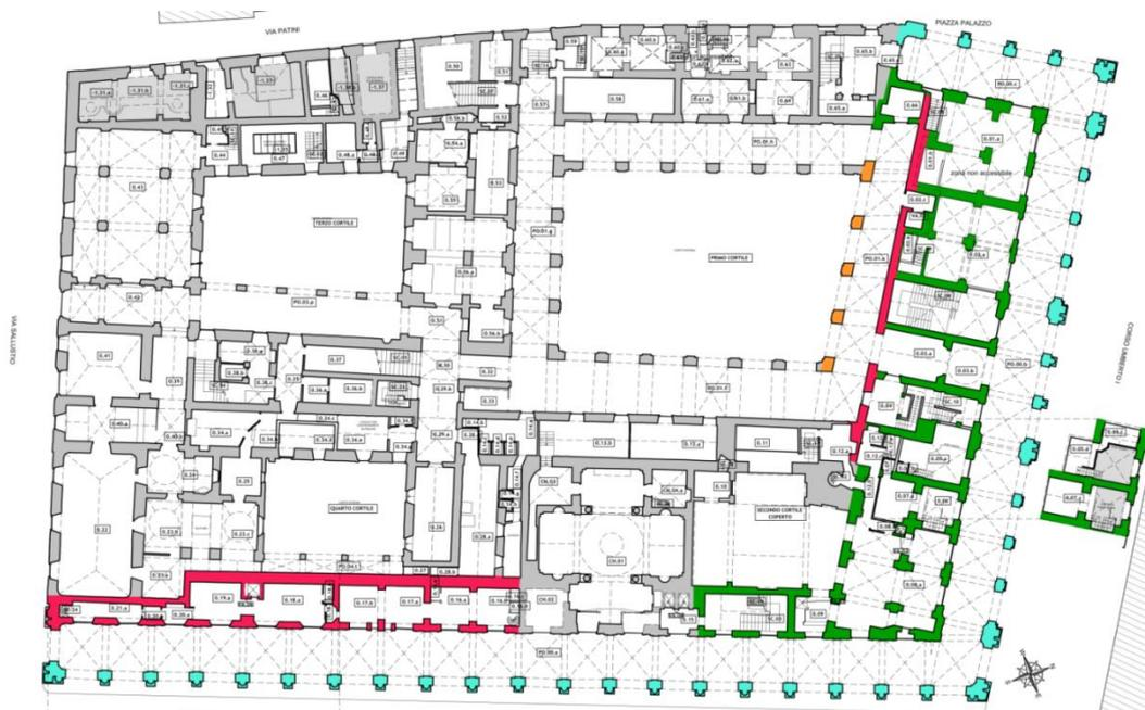
Figura 9. Mappatura dei diversi materiali riscontrati al piano terra: in verde la muratura a conci sbozzati (tipologia 1), in rosso pietrame disordinato (tipologia 2), il ciano e arancione la muratura in mattoni pieni e malta di calce rispettivamente del porticato esterno e del cortile e camera di commercio (tipologie 3 e 4).
